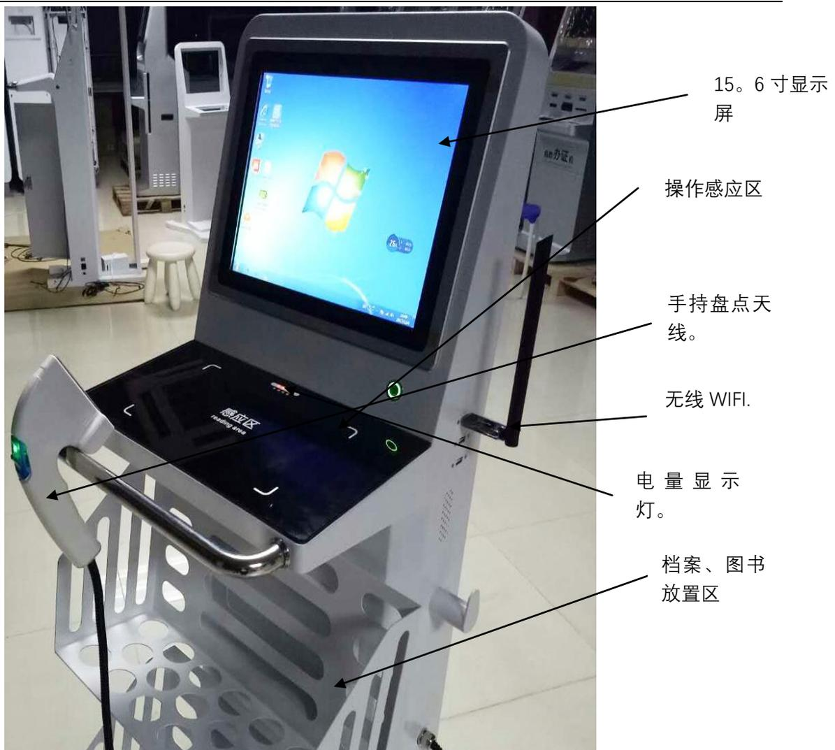
如上图所示，ST-I 型智能盘点车终端设备外部结构为机柜型，上面有触摸显示屏，中部有扫描设备平台、推手握把，前部为物品放置台。
